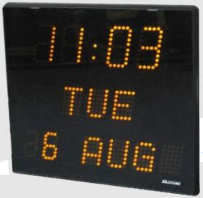
ساعت لکوموتیوران Style HMS 20mm Digit Height : 14mm Readability : 7m Accuracy : % 99.9998 .
